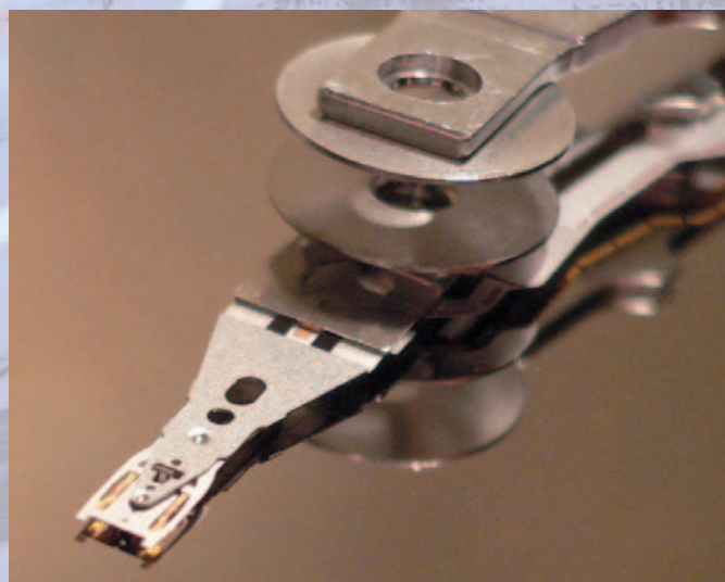
Рис. 2. Здесь, на самом кончике держателя, расположена головка
