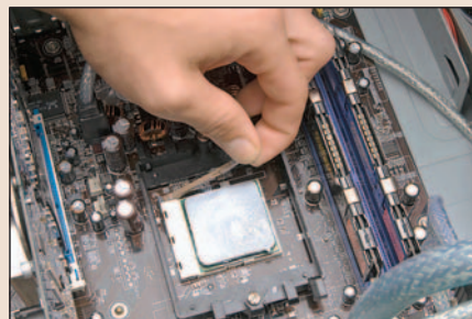
Освободите и потяните вверх маленький рычажок, чтобы извлечь старое ЦПУ (шаг 4)
